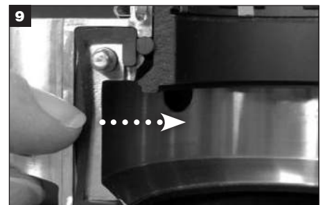
9 Quite las juntas usadas de la brida de las ranuras de la brida.
