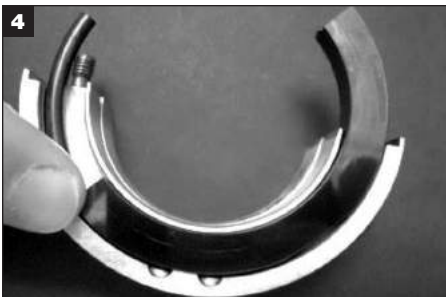
4 Quite las mitades usadas de la cara rotatoria empujando desde el extremo de la cara y deslizando fuera de la mitad del soporte rotatorio.
